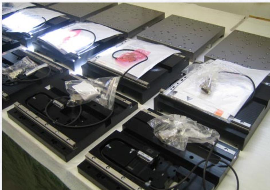
Präzisionskreuztisch der Größe 300 x 300 mit einem Genauigkeitsbereich von 1/100 mm.
